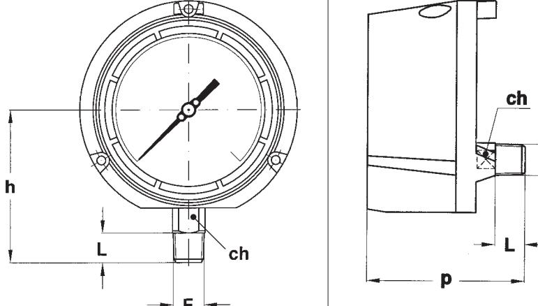
**Барабанный корпус с "прочной передней стороной"**
